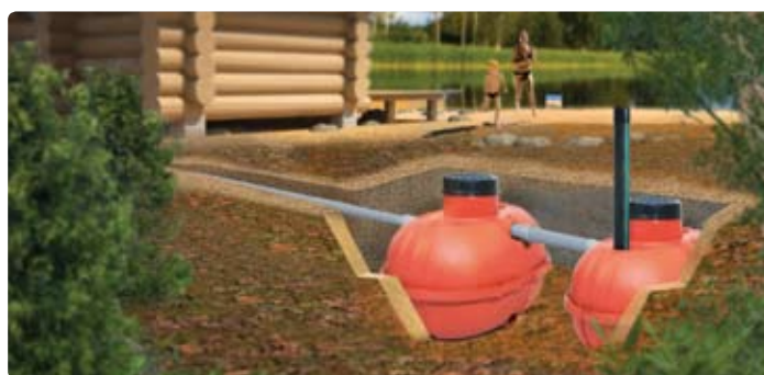
Saunasta pesuvedet johdetaan saunakaivoon ja kaivosta eteenpäin maaperään puhdistumaan. Mökkikaivo erottelee tiskivesistä kiinteät aineet sekä rasvan. Selkeytynyt vesi johdetaan eteenpäin saunakaivoon imeytettäväksi.
